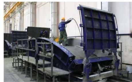
Карусельный конвейер с 8-ью производственными постами и камерой термической обработки – это высокотехнологичная рабочая линия, где последовательно выполняются операции по производству железобетонных изделий: распалубка, чистка и смазка формы, армирование, укладка бетонной смеси, отделка поверхности изделия, а также его термическая обработка. При соответствующей интенсивности термообработки в сутки реализуются два, а то и три производственных цикла твердения бетонных блоков.
