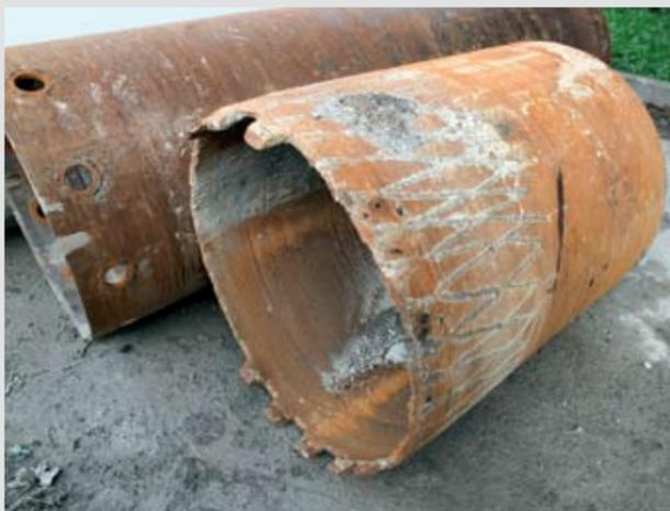
ли» сюда. А здесь бурить просто нечем. Необратимый износ металла. Толщина стенки режущей части должна быть 40 мм, а у нас – 10. Ножевые секции рвутся, ломаются, деформируются. Чего мы хотим от такого инструмента? Ни одна труба не проходит глубже 20 м... Трещины в теле трубы, обрыв зубов. Режущие части ремонтируем по два раза в день, спасает только опыт людей. Вторая машина тронуться не может – просто нечем бурить. Осталось всего две режущие коронки.
